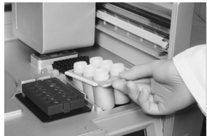
**Gambar 20. Memuat rak botol reagen. [A]** Skema posisi dan isi botol dalam rak botol reagen. **[B]** Memuat rak pada instrumen QIAcube (QIAcube ditampilkan seperti contoh).
