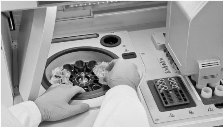
**Gambar 25. Memuat alat sentrifugasi pada instrumen QIAcube.** Muat adaptor rotor rakitan ke dalam ember sentrifugasi (QIAcube Connect MDx ditampilkan sebagai contoh).
