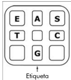
**Figura 5. Ilustração do cartucho PyroMark Q24 visto de cima.** As anotações correspondem à etiqueta nos frascos de reagente. Adicione mistura de enzimas (**E**), mistura de substrato (**S**) e nucleótidos (**A, T, C, G**) de acordo com a informação do volume indicada no relatório de informações de pré-execução que se encontra no menu "Tools" (Ferramentas) da configuração da execução.
