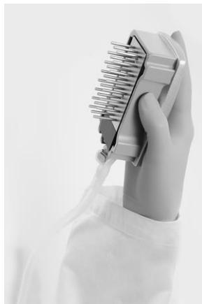
**Figura 4. Ilustração da ferramenta de vácuo levantada acima de 90° na vertical.**
