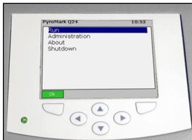
L'utilisateur contrôle l'appareil à l'aide des 6 touches situées sous l'écran.
