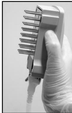
Figura 10. Ilustración de la herramienta de vacío elevada más allá de la vertical a 90°.
