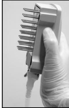
Figura 6. Ilustración de la herramienta de vacío elevada más allá de la vertical a 90°.
