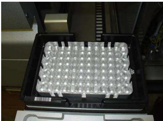
**Adaptador colocado en el marco de transferencia en la ranura 1 del cajón "Eluate".**
