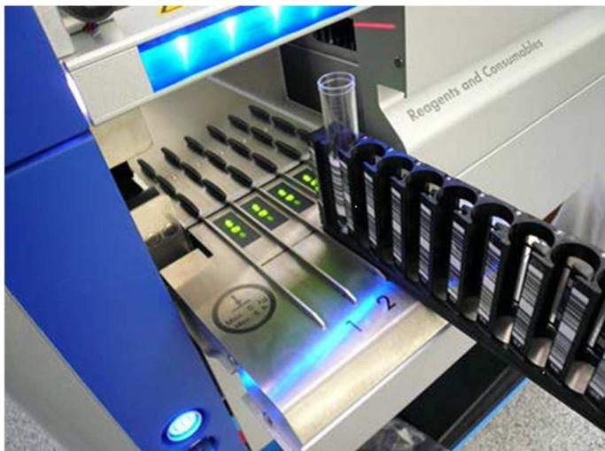
**Deslizamiento de un soporte de tubos en la ranura correspondiente.**
