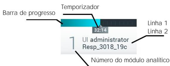
Figura 42. Barra de estado do módulo.
