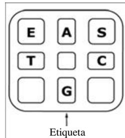
**Ilustración 4. Ilustración de la vista superior del cartucho PyroMark Q24.** Las anotaciones corresponden a la etiqueta de los viales de reactivos. Añada el volumen de mezcla de enzimas (**E**), mezcla de sustratos (**S**) y nucleótidos (**A**, **T**, **C**, **G**) que se indica en la información sobre volúmenes del informe de información previa de la serie, que encontrará en el menú "Tools" (Herramientas) durante la configuración del ensayo.
