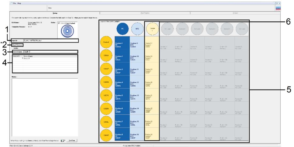
Figura 13. Inserindo o "Run ID" (ID da execução) e o "Sample Name" (Nome da amostra). 1 = campo de diálogo "Run ID" (ID da execução); 2 = "Import Samples" (Importar amostras) (não está disponível na versão 2.1 do software); 3 = campo de diálogo "Sample Name" (Nome da amostra); 4 = Lista de amostras; 5 = painel "Layout of the pipetting adapter" (Configuração do adaptador de pipetagem); 6 = círculo de amostra e coluna de 8 ensaios abaixo realizados.
