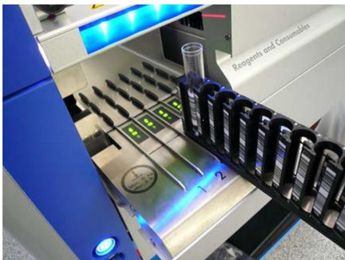
Deslizando um transportador de tubo no slot apropriado.
