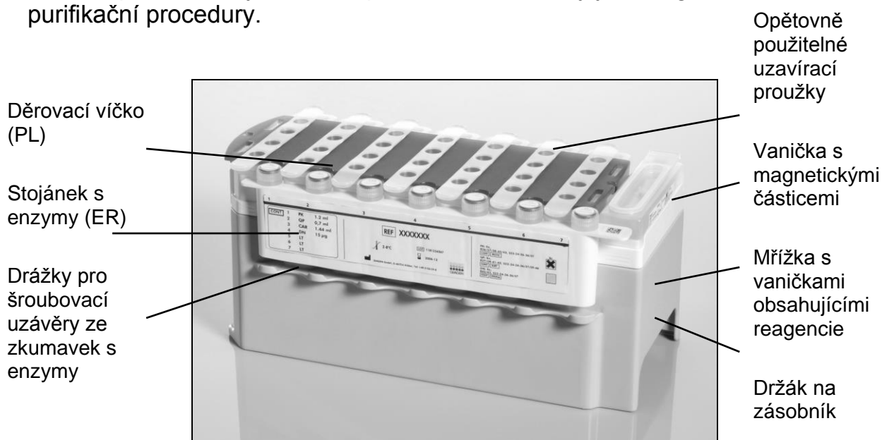
Obrázek 2. Zásobník reagensií (RC) QIASymphony. Zásobník reagensií (RC) obsahuje všechny reagensie potřebné pro chod protokolu.
