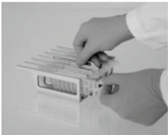
図 3. 試薬カートリッジを使用した簡便なセットアップ。 (A) 密封した充填済み試薬カートリッジ。充填レベルは、試薬カートリッジのタイプによって異なります。(B) 試薬カートリッジをカートリッジラックにセットします。カートリッジラック自体には、試薬カートリッジをセットする方向を示した矢印のラベルが付いています。
