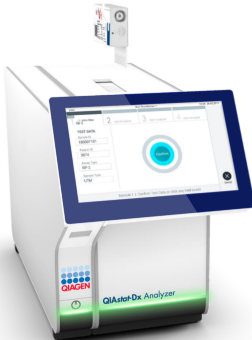
Gambar 28. Memasukkan QIAstat-Dx Respiratory SARS-CoV-2 Panel Cartridge ke dalam QIAstat-Dx Analyzer 1.0.
