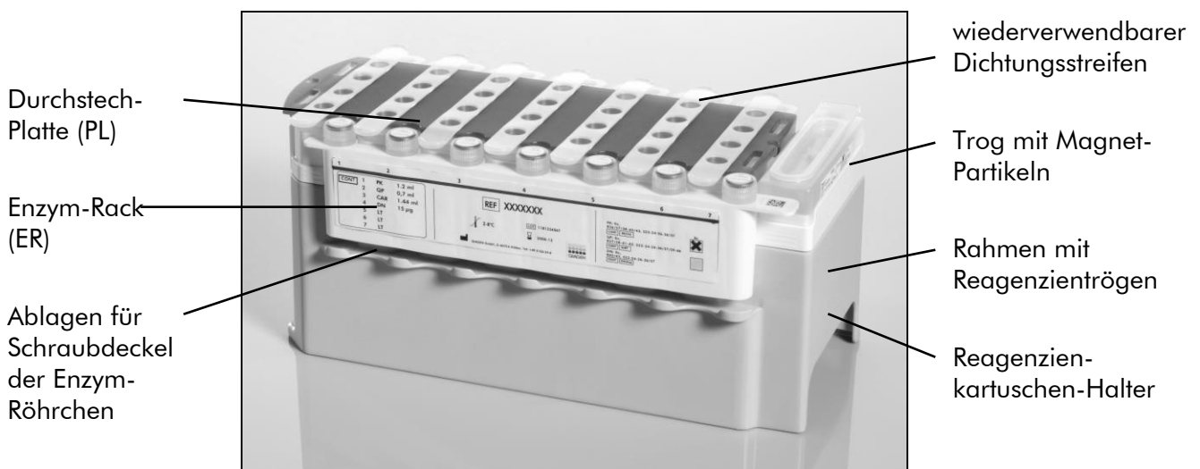
Abbildung 2. QIASymphony Reagenzienkartusche (RC). Die Reagenzienkartusche enthält alle Reagenzien, die für den Protokolllauf benötigt werden.
