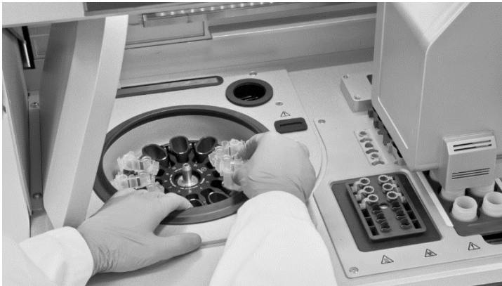
Figure 25. Chargement de la centrifugeuse sur les instruments QIAcube. Charger les adaptateurs pour rotor montés dans les godets de la centrifugeuse (QIAcube Connect MDx montré à titre d'exemple).
