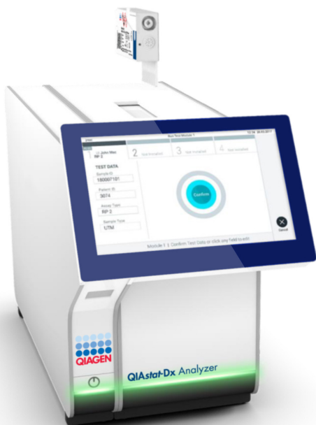
28. ábra A QIAstat-Dx SARS-CoV-2/Flu A/B/RSV Panel Cartridge kazetta behelyezése a QIAstat-Dx Analyzer 1.0 készülékbe.
