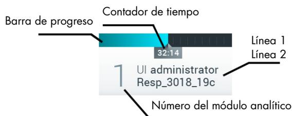
Figura 43. Barra de estado del módulo.
