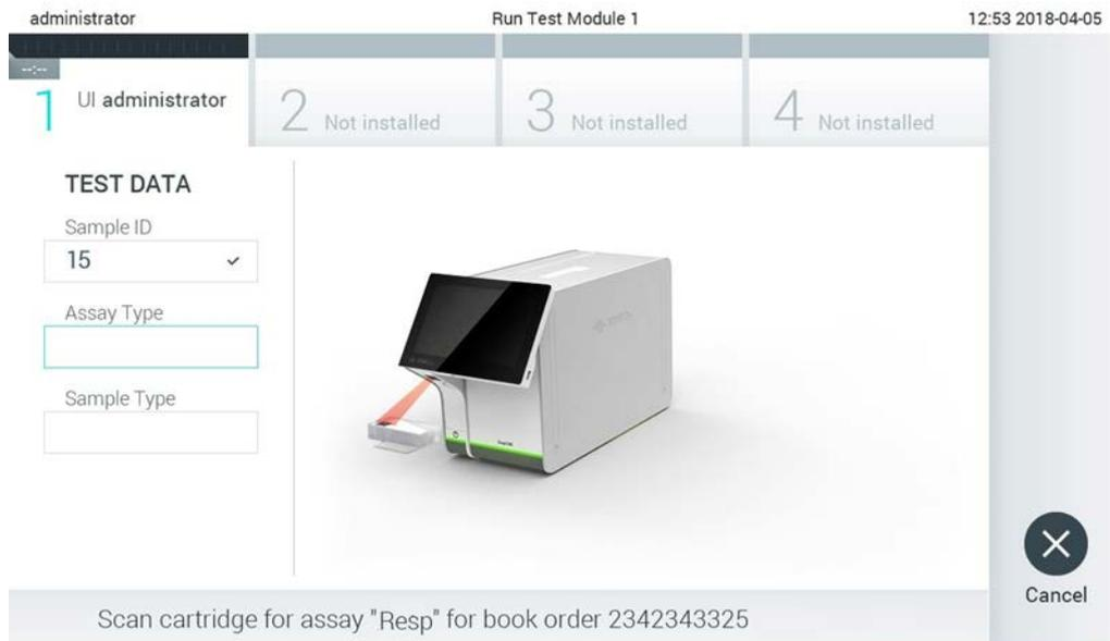
Figura 77. Escaneo del código de barras del cartucho de ensayo QIAstat-Dx.
