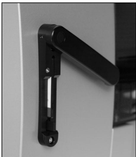
Figur 2. Kort fullständigt infört i öppningen för EZ1 Card.
