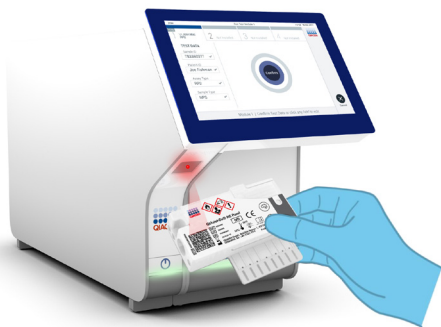
Afbeelding 12. Streepjescode van de QIAstat-Dx Meningitis/Encephalitis Panel Cartridge scannen.
