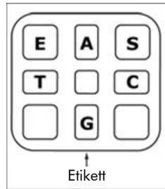
Figur 5. Illustrasjon av PyroMark Q24-kassetten sett ovenfra. Kommentarene svarer til etiketten på reagensflaskene. Tilsett enzymblanding (E), substratblanding (S) og nukleotider (A, T, C, G) i samsvar med det volumet som er angitt i rapporten som inneholder informasjon før analyse i menyen "Tools" (Verktøy) i analyseoppsettet.
