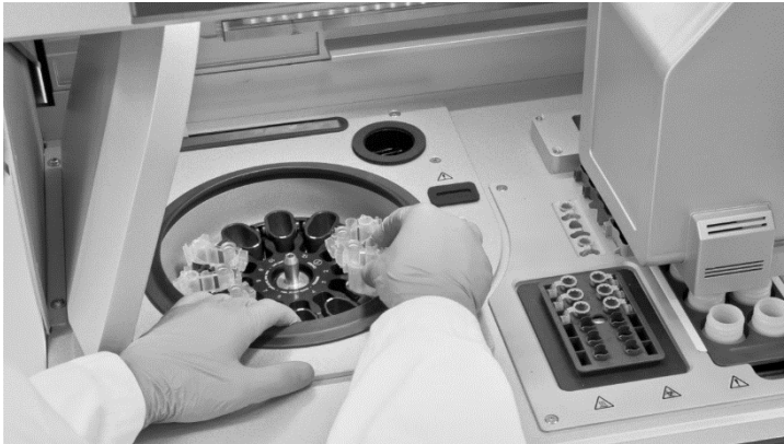
Hình 25. Nạp máy ly tâm vào các dụng cụ QIAcube. Nạp các bộ tiếp hợp rôto đã lắp ráp vào thùng máy ly tâm (QIAcube Connect MDx được minh họa làm ví dụ).
