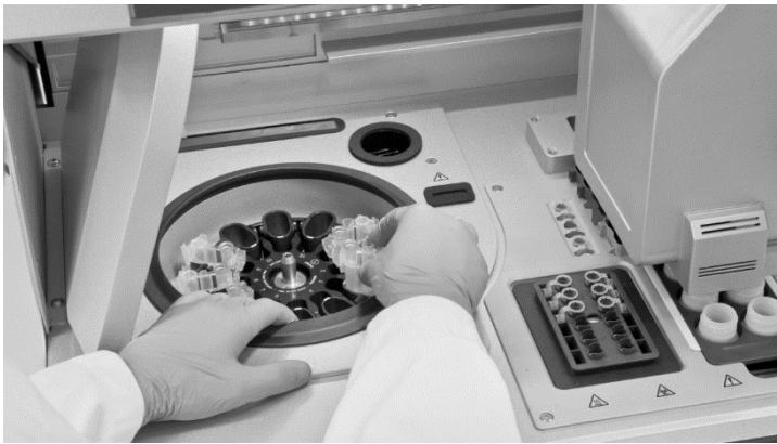
Figur 25. Placering af centrifugen på QIAcube-instrumenter. Placer de samlede rotoradaptere i centrifugespandene (QIAcube Connect MDx er vist som eksempel).
