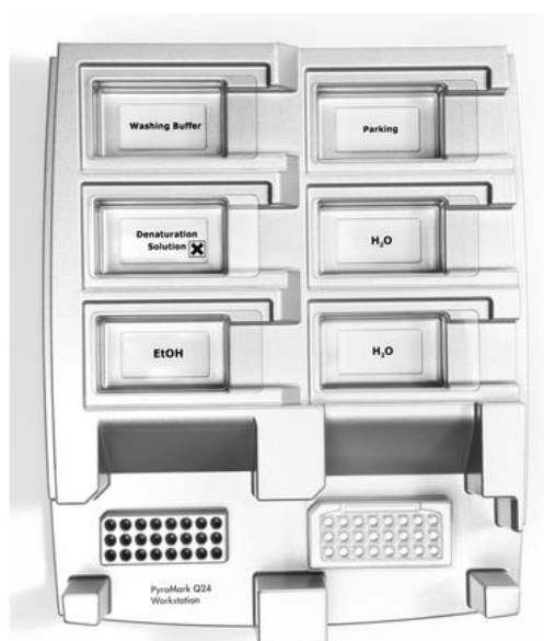
Figure 2. Placement de la plaque (ou des barrettes) de PCR et de la plaque PyroMark Q24 sur la station de travail sous vide.
