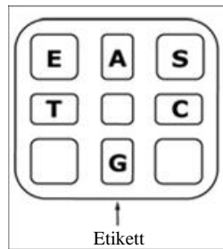
Bild 4. PyroMark Q24-kassetten sedd ovanifrån. Märkningarna motsvarar etiketterna på reagensflaskorna. Tillsätt enzymblandning (E), substratblandning (S) och nukleotider (A, T, C, G) enligt den mängd som anges i rapporten Pre Run [Info före körning] på menyn "Tools" [Verktyg] vid körningskonfigurationen.
