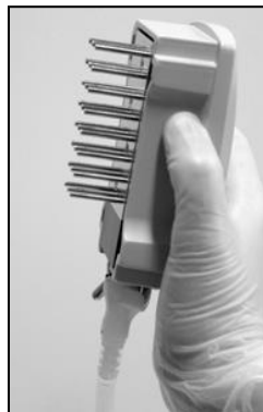
Bild 3. Bilden visar vakuumverktyget i mer än 90° lodrät lutning.
