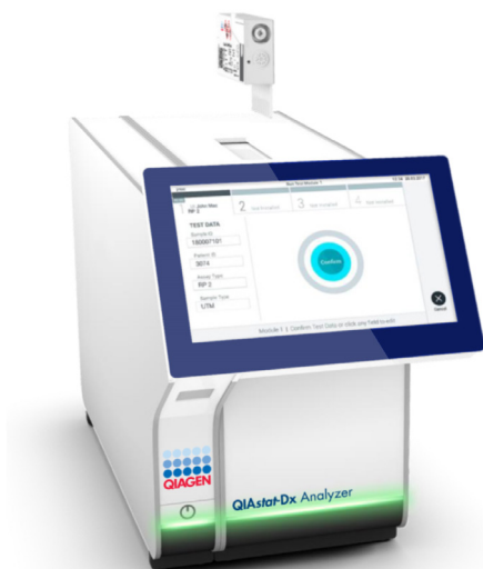
Фигура 14. Поставяне на QIAstat-Dx ME Panel Cartridge в QIAstat-Dx Analyzer 1.0.
