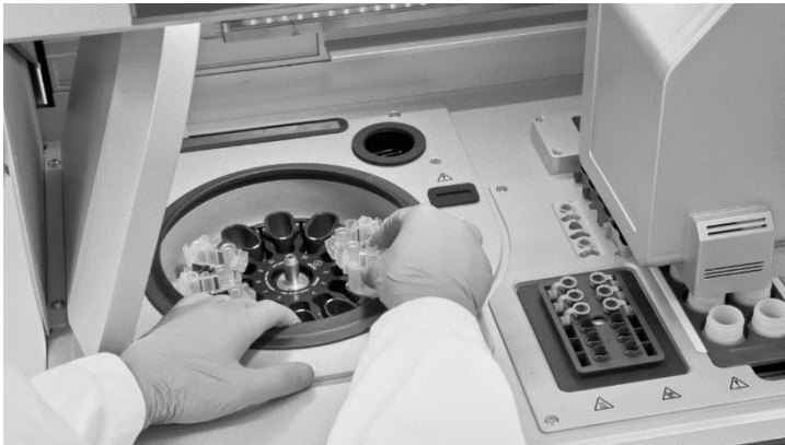
Εικόνα 25. Φόρτωση της φυγόκεντρου στα όργανα QIAcube. Τοποθετήστε τους συναρμολογημένους προσαρμογείς ρότορα εντός των κάδων της φυγόκεντρου (το QIAcube Connect MDx παρουσιάζεται ως παράδειγμα).
