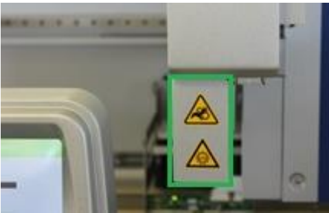
* A zúzódásveszélyre figyelmeztető címke és az UV-fényre figyelmeztető címke helyzete (SP/AS).
