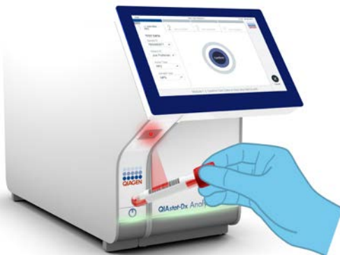
Afbeelding 24. Streepjescode van de monster-ID scannen.
