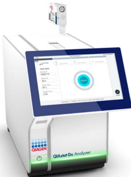
Afbeelding 28. De QIAstat-Dx SARS-CoV-2/Flu A/B/RSV Panel Cartridge in de QIAstat-Dx Analyzer 1.0 plaatsen.
