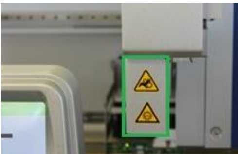
* Θέση της ετικέτας προειδοποίησης κινδύνου σύνθλιψης και της ετικέτας προειδοποίησης υπεριώδους ακτινοβολίας (SP/AS).
