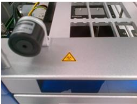
* Ετικέτα προειδοποίησης βιολογικού κινδύνου στην τράπεζα εργασίας, κοντά στη μαγνητική διάταξη ασφάλισης του καλύμματος (QSYS-AS)
