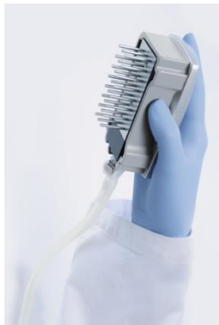
4 pav. Vakuuminio įrankio, pakelto didesniu nei 90° vertikaliu kampu, iliustracija.
