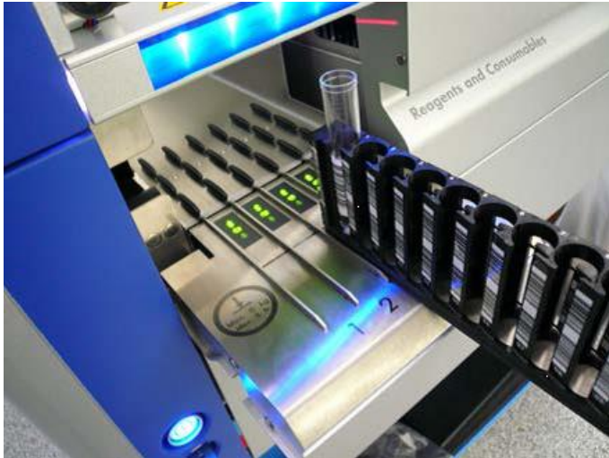
Posunutie stojanu na skúmavky do príslušného bloku.
