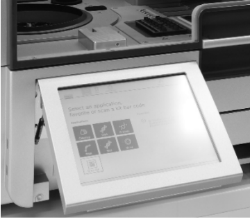
그림 19. QIAcube Connect MDx 의 꺼내진 터치스크린
