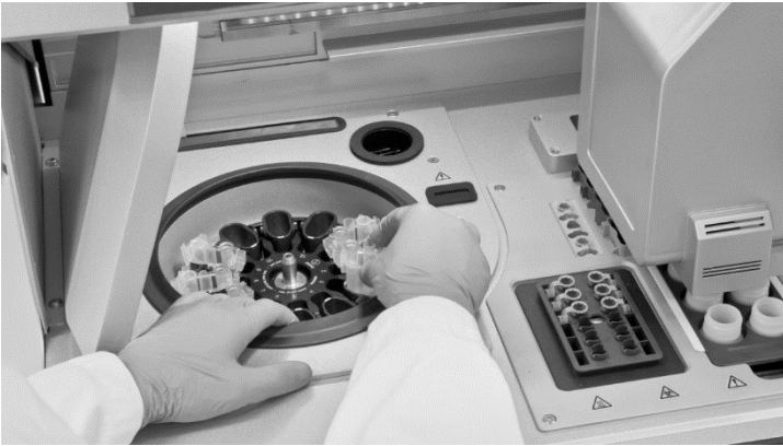
그림 25. QIAcube 기기에 원심분리기 로딩. 조립된 로터 어댑터를 원심분리기 버킷에 로딩합니다(QIAcube Connect MDx 가 예로 나와 있음).
