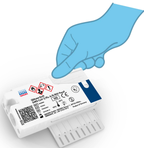
Ryc. 22. Zamykanie pokrywy próbek portu głównego.
