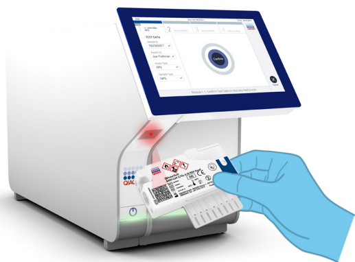
Ryc. 25. Skanowanie kodu kreskowego kasety QIAstat-Dx SARS-CoV-2/Flu A/B/RSV Panel Cartridge.
