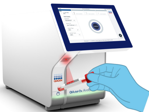
Ryc. 24. Skanowanie kodu kreskowego id. próbki.
