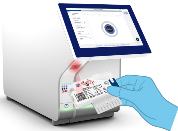
Ryc. 12. Skanowanie kodu kreskowego kasety QIAstat-Dx SARS-CoV-2/Flu A/B/RSV Panel Cartridge.
