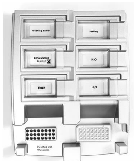
Εικόνα 2. Τοποθέτηση της πλάκας (ή των ταινιών) PCR και της πλάκας PyroMark Q24 στο σταθμό εργασίας υπό κενό.
