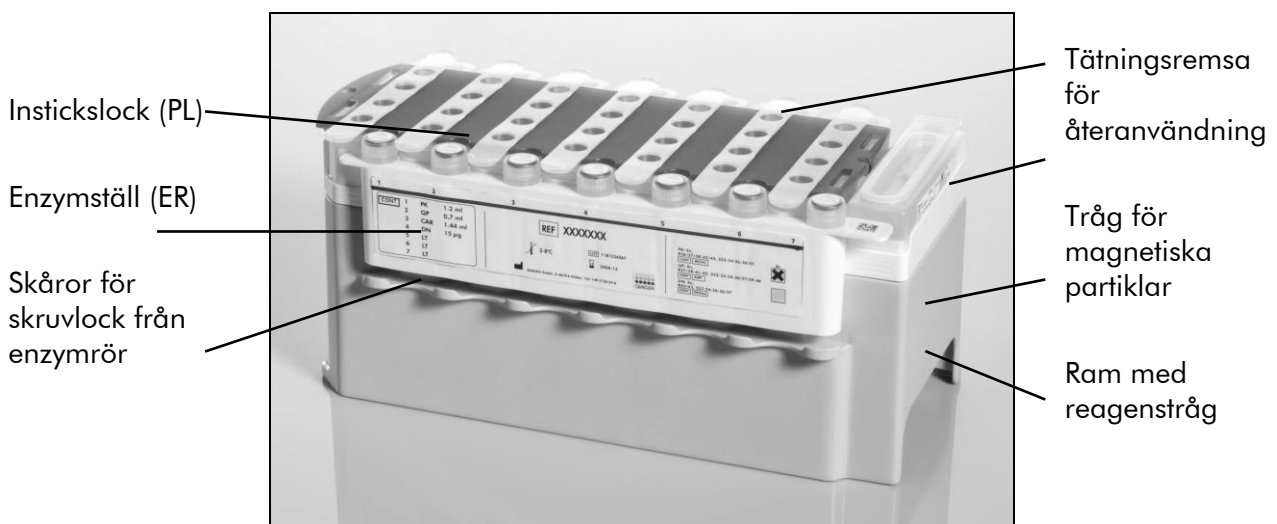
Figur 2. QIAasymphony reagenskasset (RC). Reagenskassetten (RC) innehåller alla reagenser som behövs för protokollkörningen.
