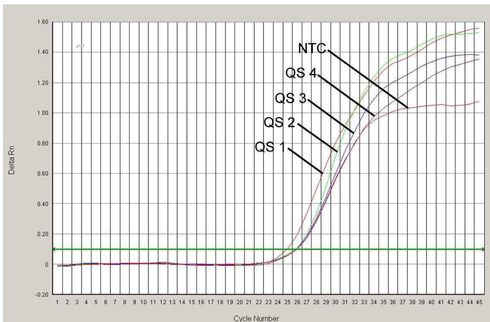
Fig. 23: Detecção do Controlo interno (IC) através da detecção de um sinal de fluorescência VIC ( ABI PRISM 7000 SDS ) no caso de amplificação simultânea dos Padrões de quantificação ( HSV2 LC/RG/TM QS 1 - 4 ). NTC: non-template control (controlo negativo).
