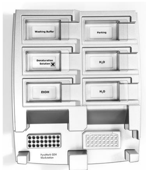
Figura 3. Posizionamento della piastra per PCR (o delle strisce) e della piastra PyroMark Q24 sulla stazione del vuoto.
