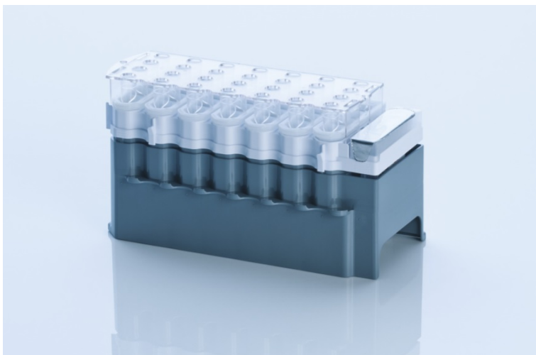
Figur 4. QIASymphony-reagenskasset (RC). RC-en inneholder alle reagenser som kreves for protokollkjøringen.
