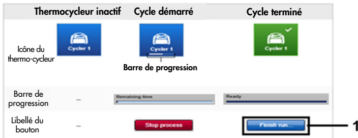
Figure 14. Achèvement d'un cycle. 1 = « Finish run » (Terminer le cycle).
