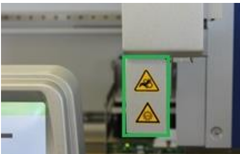
* Местоположение на предупредителния етикет за опасност от смачкване и на този за УВ светлина (SP/AS).
