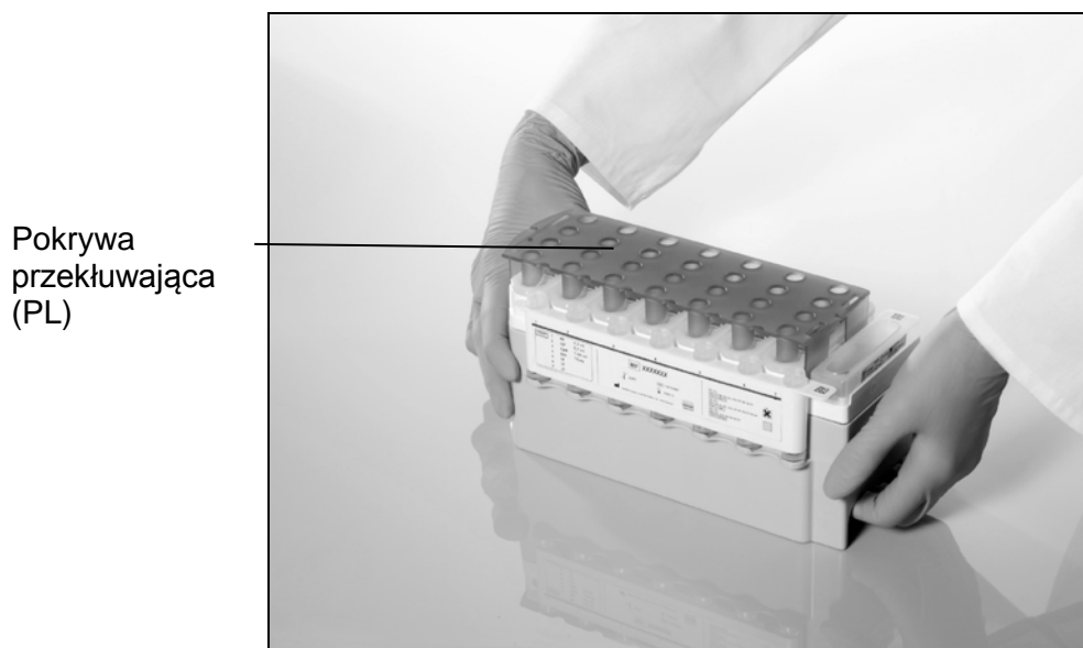
Rys. 3. Prosta instalacja kartridża z odczynnikami (RC) na blacie roboczym.
