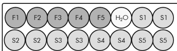
Figur 7. Rekommenderad plattuppställning för ett (1) experiment. S: cDNA-prov; F1–5: BCR-ABL Mbc-standarder; C1–3: ABL-standarder; H 2 O: vattenkontroll.
