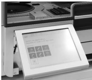
Obrázok 19. Vysunutá dotyková obrazovka prístroja QIAcube Connect MDx
