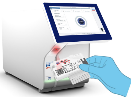
Figur 12. Scanning af stregkoden på QIAstat-Dx Meningitis/Encephalitis Panel Cartridge.
