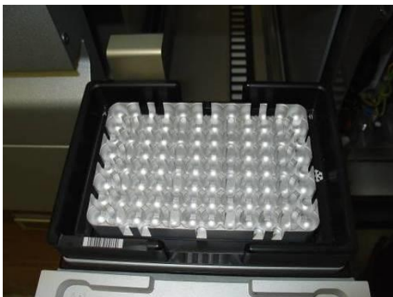
Adapters, kas novietots uz pārsūtīšanas rāmja uz “eluāta” atvilktnes 1. slota.
