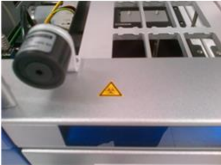
* Bioloģiskā apdraudējuma brīdinājuma uzlīme uz darbgalda pie pārsega magnētiskā bloķētāja (QSYS-AS)
