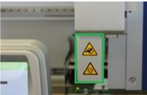
* Iespiešanas riska brīdinājuma uzlīmes un UV gaismas brīdinājuma uzlīmes pozīcija (SP/AS).
