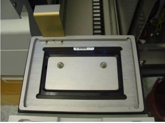
"Elüat" çekmecesinin slot 1'ine yerleştirilmiş aktarım çerçevesi.
