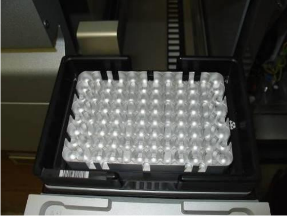
"Elüat" çekmecesinin slot 1'indeki aktarım çerçevesine yerleştirilmiş adaptör.
