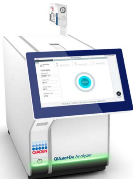
Figura 28. Inserimento della QIAstat-Dx SARS-CoV-2/Flu A/B/RSV Panel Cartridge nel QIAstat-Dx Analyzer 1.0.
