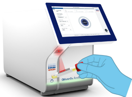
Slika 11. Očitavanje crtičnog koda ID-ja uzorka.
