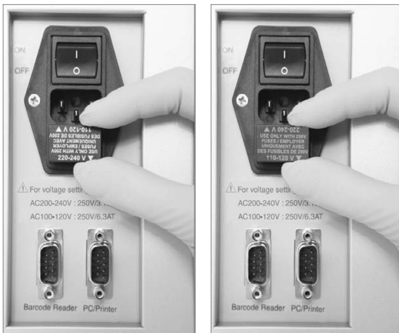
Selección del fusible correcto para una conexión eléctrica de 200-240 V. Selección del fusible correcto para una conexión eléctrica de 100-120 V.
