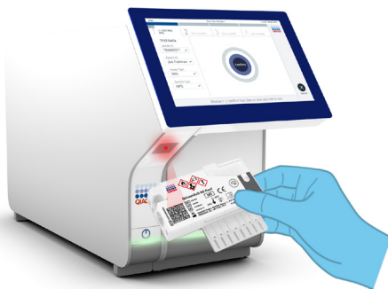
Figura 12. Digitalização do código de barras do QIAstat-Dx Meningitis/Encephalitis Panel Cartridge.
