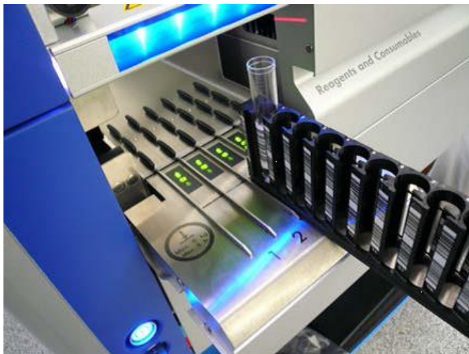
Putkikuljettimen liu'uttaminen aukkoonsa
