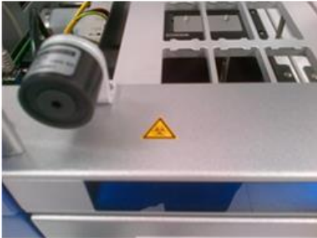
* Biologinen vaara -merkintä työalustassa, suojuksen magneettilukon lähellä (QSYS-AS)
